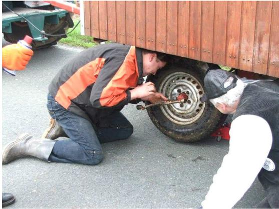
Wir waren gut in Fahrt, als sich bei einem Bauwagen vorne-links ein Rad löste und nach links in den Straßengraben rollte. Das Zugfahrzeug, ein Hanomag Robust, bemerkte dieses nicht sofort, so dass die Bremstrommel eine deutliche Spur auf dem Asphalt hinterließ. Die vorausfahrenden, HOK und Kurt, bekamen hiervon nichts mit. Marcel kramte aus seinem
